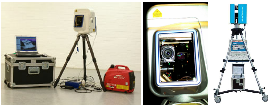
Abb.2: Das 3D-Laserscanning-System Mensi GS100 der HAW Hamburg mit Zubehör (links), GS100-Innenansicht mit digitaler Kamera und Spiegel (Mitte), IMAGER 5003 mit Zubehör (rechts)
