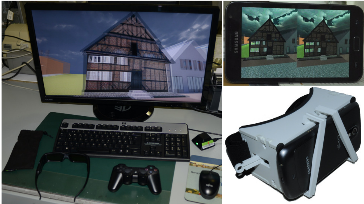
Abb. 4: 3D-Monitor mit Visualisierung durch Nvidia 3D Vision (links) und Smartphone mit stereoskopischen Bildpaar in einer Halterung als Virtual-Reality-Brille (rechts)
